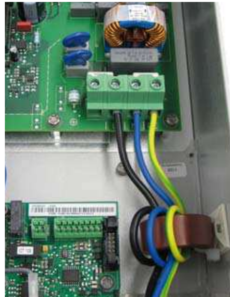
Bild 14: AC-Leitungen um die Ferritkerne gewickelt
