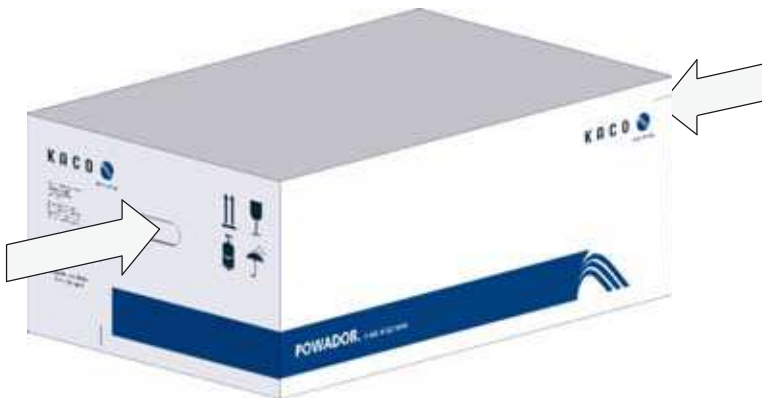
Bild 6: Transport des Wechselrichters
